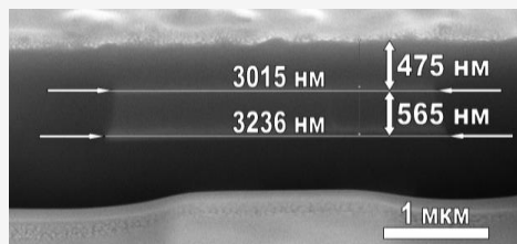
Изображение сечения, сделанного с помощью фокусированного ионного пучка
