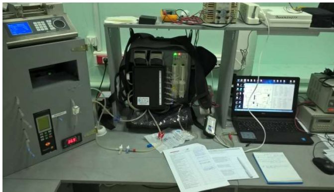
Фотография лабораторных испытаний носимого аппарата для искусственного очищения крови с непрерывной регенерацией отработанного диализирующего раствора
