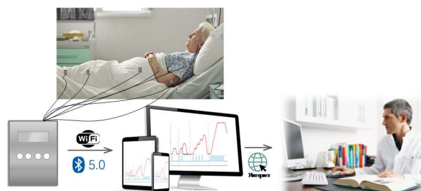
Комплекс тензодатчиков для мониторинга мышечной активности в постинсультный период реабилитации пациента
