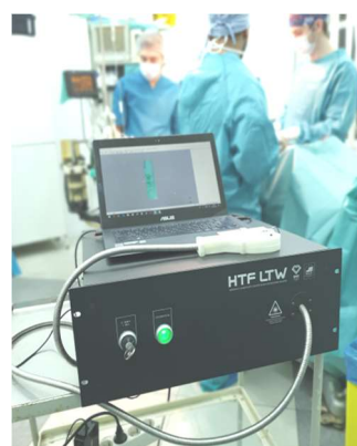
Фотография аппарата для лазерного сваривания биологических тканей при проведении хирургической операции по восстановлению дефектов сердца
