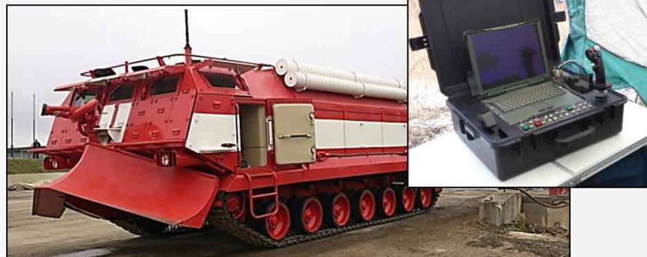
**Дистанционное управление роботизированным комплексом пожаротушения**
